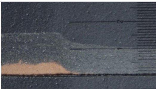
Darstellung der Quellung und Erweichung einer Beschichtung nach Einwirkung von Reinigungsmittel und Ausführung des neuen Kratztests
